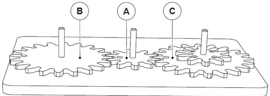
Tourner la roue dentée **B** dans un sens et noter sur le dessin avec une flèche, le sens de rotation des roues dentées **B, A, C**.
