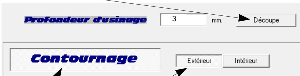
17) Cliquer sur **Contournage**, puis **Extérieur** et enfin cliquer sur suivant.
