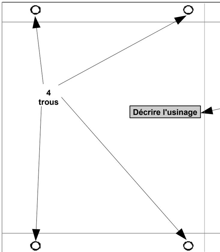
8) Sélectionner les différents trous comme sur l'image ci-dessus en faisant un cadre autour, ils doivent ensuite apparaître en noir. Faites clic droit et cliquer sur **Décrire l'usinage**.
