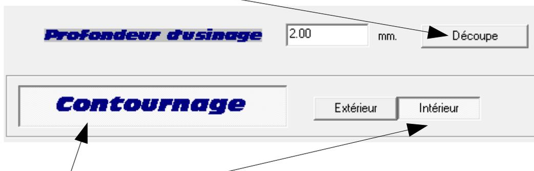
11) Cliquer sur **Contournage**, puis **Intérieur** et enfin cliquer sur suivant.
