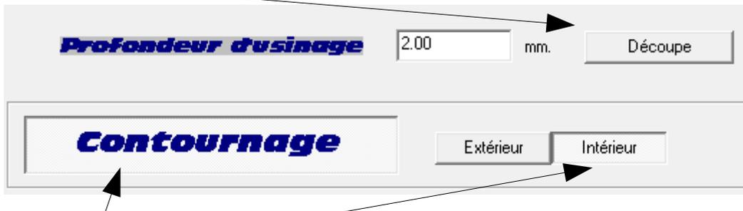
11) Cliquer sur **Contournage**, puis **Intérieur** et enfin cliquer sur suivant.
