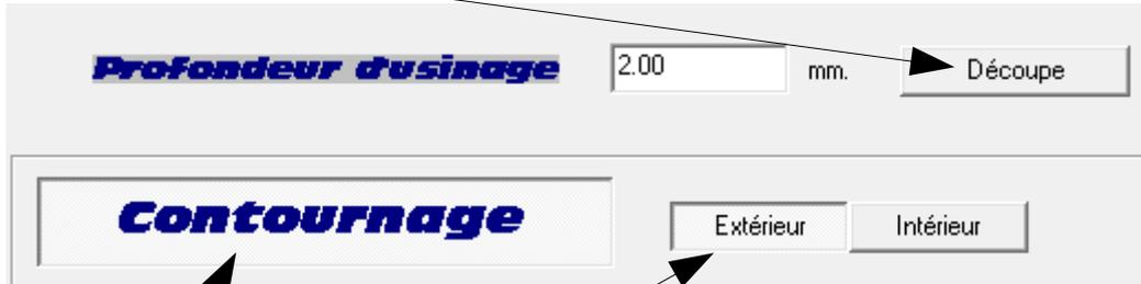
17) Cliquer sur **Contournage**, puis **Extérieur** et enfin cliquer sur suivant.
